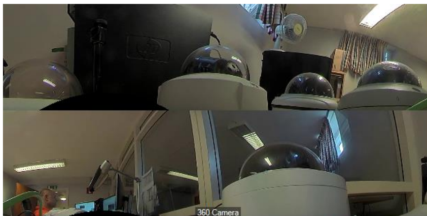
Optimalt bildförhållande på kameravyn med dewarpläge 'Dubbel panoramavy, fast bildförhållande' är: 2:1
