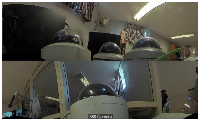
Optimalt bildförhållande på kameravyn med dewarpläge 'Dubbel panoramavy' är: bredare än 4:3
